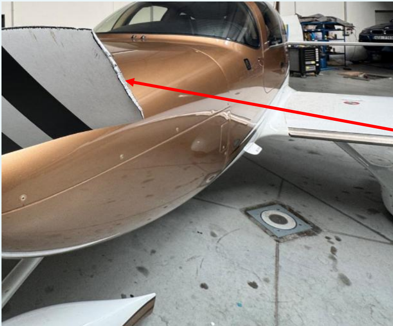
Poškození listů vrtule
